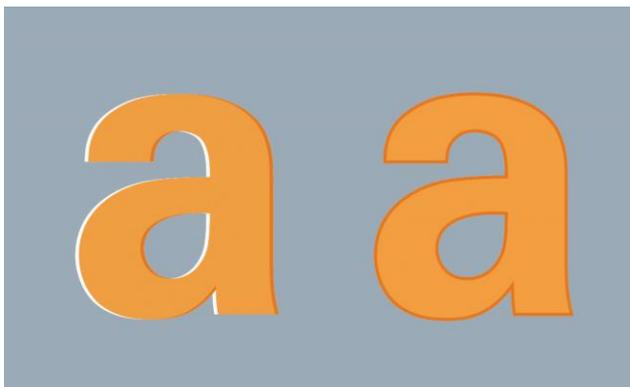
1. Das linke „a“ zeigt das Druckergebnis ohne Trapping (weiße Blitzer) – das rechte „a“ veranschaulicht das Druckergebnis mit Trapping-Verfahren.
